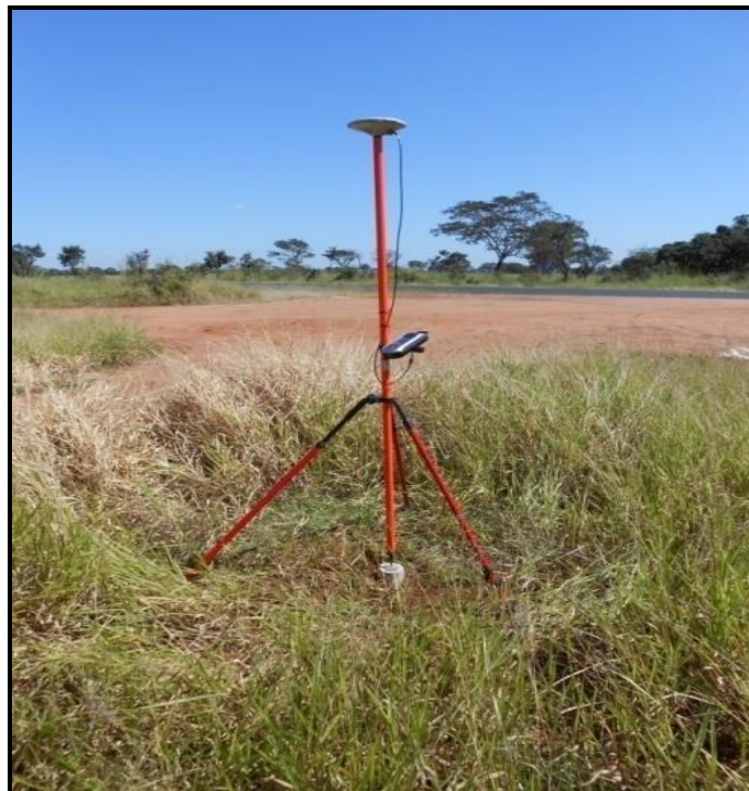
Figura 1 Determinação das coordenadas de ponto materializado na superfície topográfica, também denominado de marco, por meio da utilização de um receptor GPS de simples frequência (L1).
