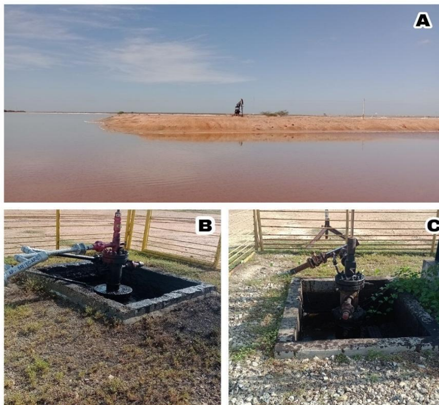
Figura 7 – Principais impactos relacionados à atividade de petróleo onshore na planície de flúviomarina do rio Apodi-Mossoró. A: Aterramento de áreas úmidas para instalação de estação petrolífera. B: Poço de petróleo apresentando vazamento em contato direto com o solo e vegetação. C: Poço com unidade de bombeio desativada apresentando acúmulo de óleo em sua base. Fonte: Elaborado pelos autores (2023).
