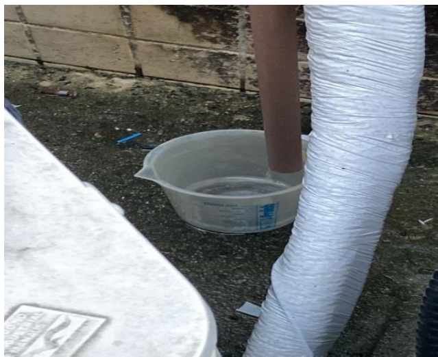
Figura 4. Teste de coleta da água expelida pelo aparelho de ar-condicionado
