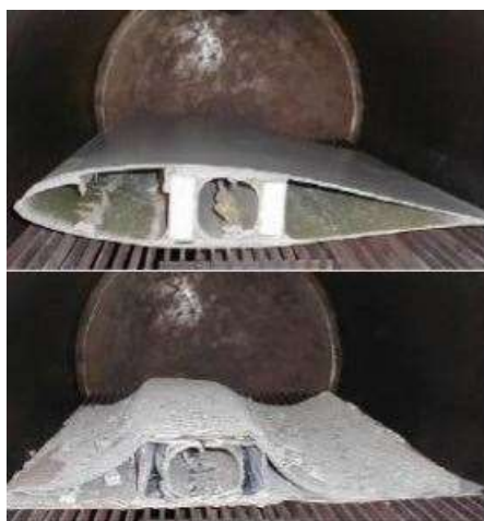
Figura 7. Fotografias do “antes e depois” de uma pá eólica submetida ao processo de pirólise. Adaptado de Larsen [2009].
