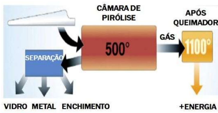
Figura 6. Esquema do processo de pirólise. Adaptado da Larsen [2009].
