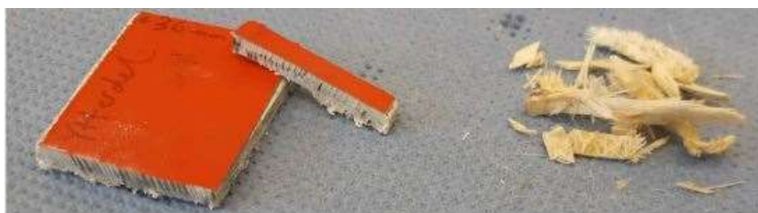
Figura 8. Solvólise de um pedaço maior de uma pá de turbina eólica. Adaptado de Mattsson [2020].
