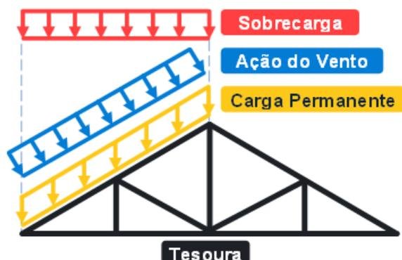
Figura 3. Posição dos carregamentos no telhado
