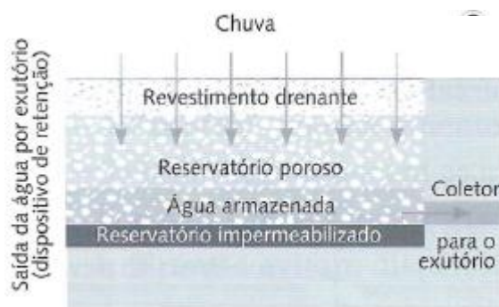
Figura 3. Pavimento com reservatório estrutural
