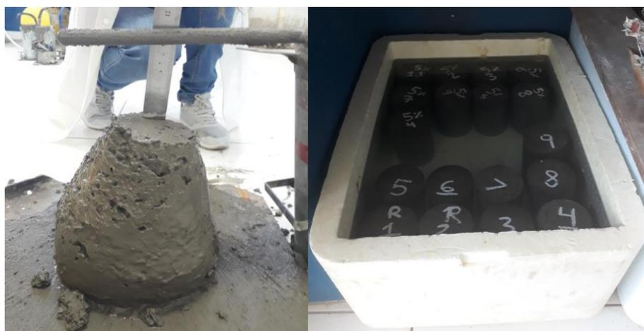
Figura 2. Slump Test e corpos de prova para rompimento.
