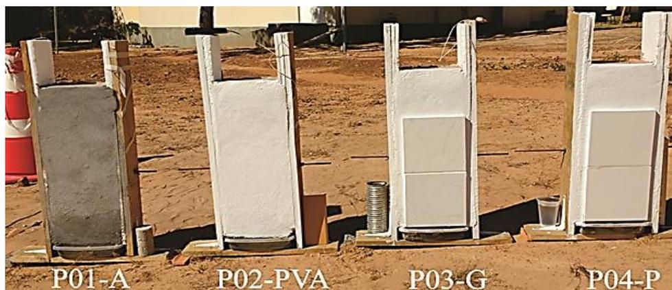
**Figura 6. Imagem digital dos protótipos com incidência direta do sol na face revestida.**
