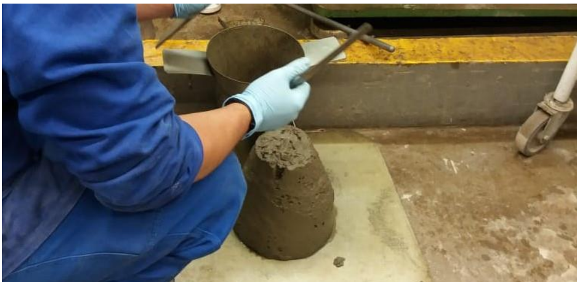
Figura 2. Determinação da consistência pelo abatimento do tronco de cone
