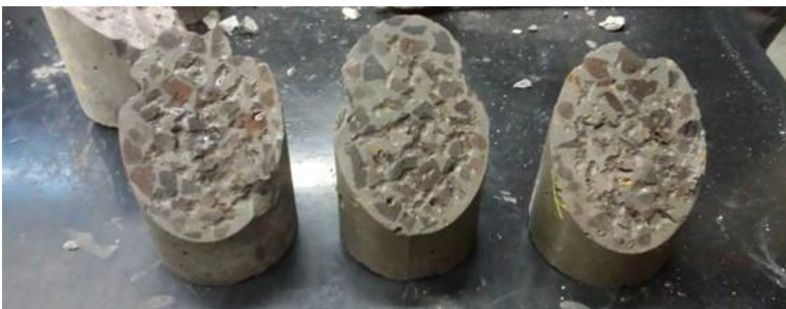
Figura 3. Apicoamento e limpeza superficial dos corpos de prova
