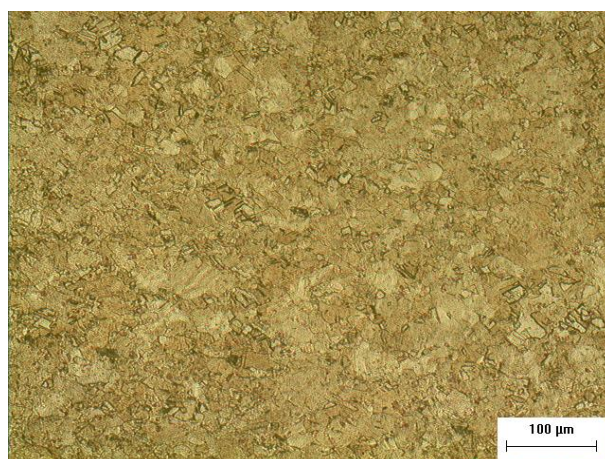
Figura 7. Microestrutura do cobre laminado a 20% na direção normal à laminação (Autor, 2021).
