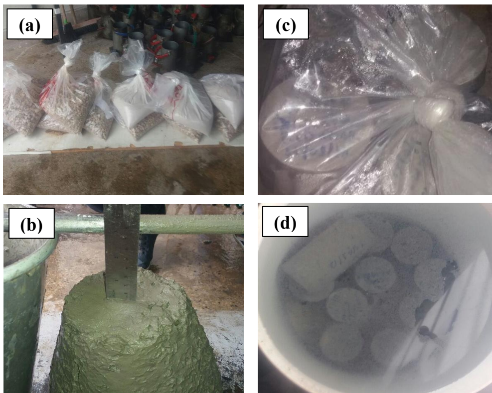
Figura 1. (a) Material Pesado e Separado. (b) Teste de Abatimento. (c) Cura em saco plástico. (d) Cura em água.
