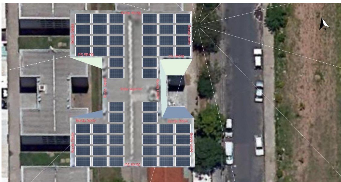
Figura 6. Posicionamento dos painéis fotovoltaicos em um dos prédios do Residencial Santa Lúcia. Fonte: PVSol.
