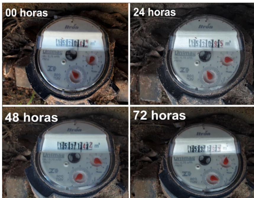
Figura 6. Fotos do hidrômetro na aferição do 2º ciclo com meia seção do registro (Batista, 2019)
