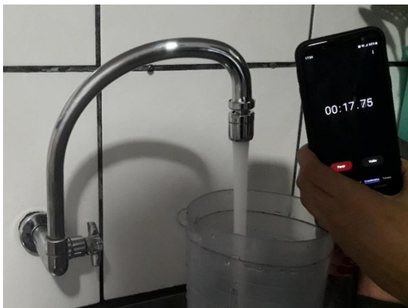
Figura 2. Execução do ensaio com instalação do arejador (Batista, 2019)
