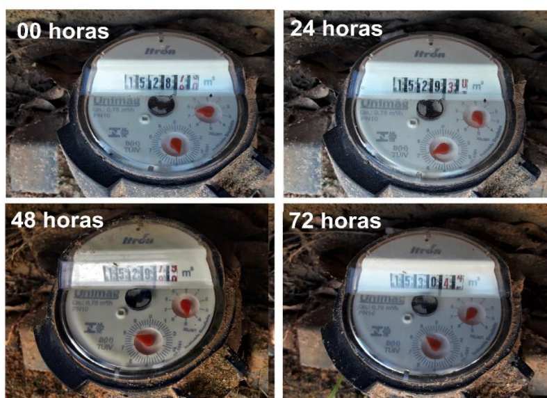
Figura 5. Foto do hidrômetro do 1º ciclo de aferições com o registro totalmente aberto (Batista, 2019)
