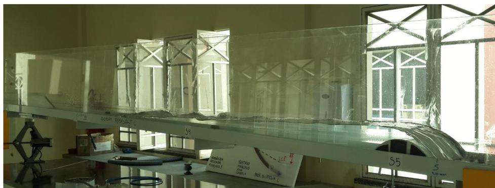
**Figura 11. Ressalto ocorrido com  $I = 3\%$  com dois obstáculos com segundo na seção 5.**
