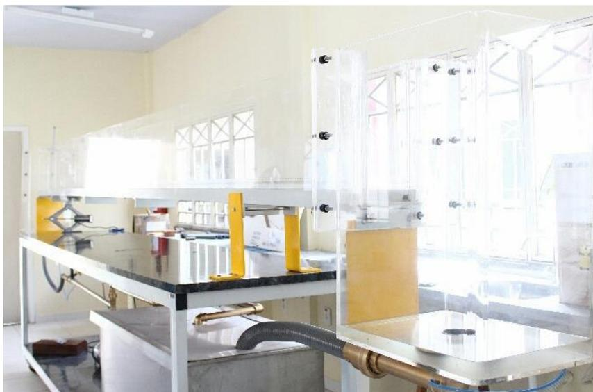
Figura 1. Canal modelo em acrílico cristal - Laboratório de Hidráulica e Recursos Hídricos do NUPENG da UFRR.
