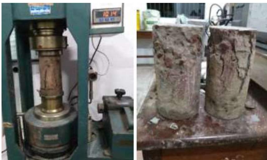
Figura 6. Ensaio de compressão axial e amostra do concreto após o rompimento
