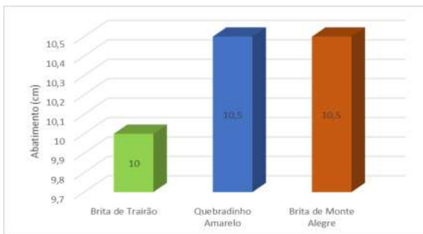
Figura 5. Comparativos sobre os abatimentos dos agregados
