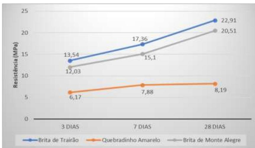
**Figura 7. Demonstrativo do ganho de resistência dos corpos de prova conforme seu período de cura**
