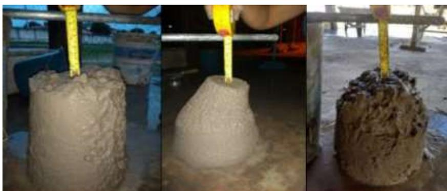
**Figura 3. Abatimento das amostras de concreto confeccionados com a brita do Trairão, brita de Monte Alegre e com o “quebradinho amarelo”, respectivamente**
