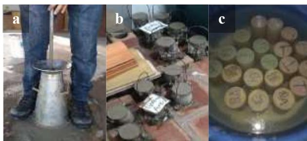
Figura 4. a) processo de apiloamento do concreto; b) processo de identificação dos corpos de prova; c) corpos de prova no processo de cura.
