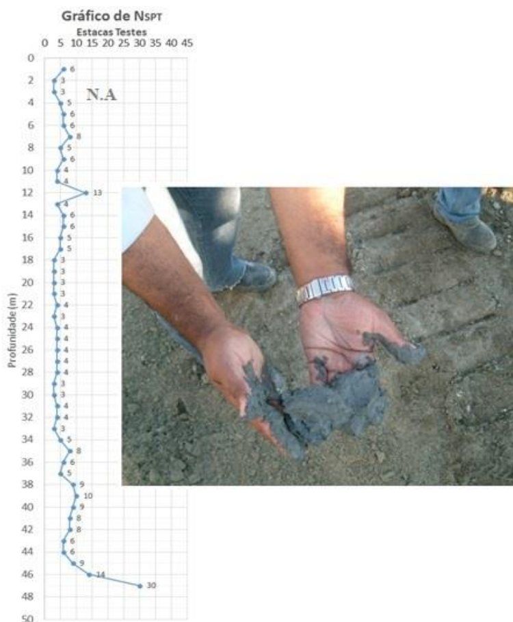
Figura 5. Perfil do solo junto a estaca teste e detalhe da amostra local
