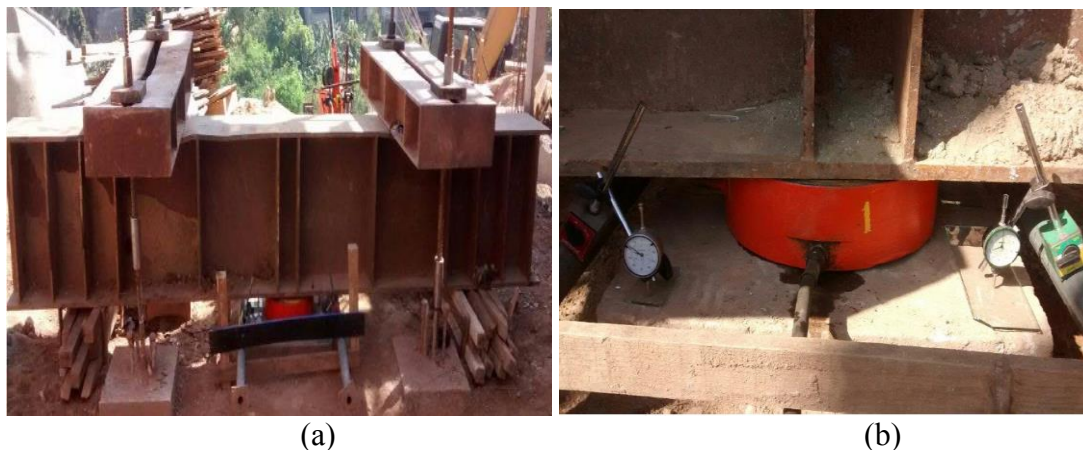
Figura 6. (a) Detalhe da prova de carga estática, (b) detalhe extensômetros apoiados sobre placa de vidros
