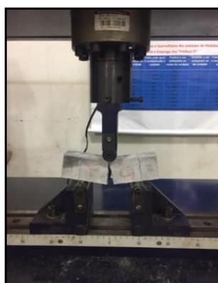
Figura 5. Ensaio de tração na flexão
