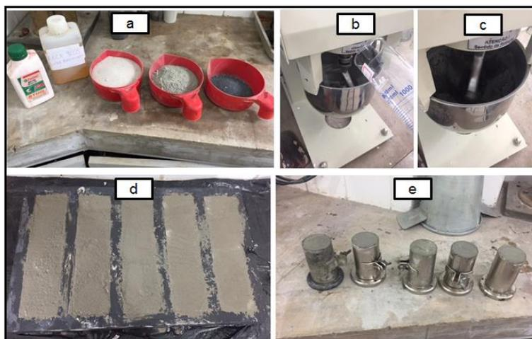
Figura 4. Etapas da produção e moldagem dos corpos-de-prova de argamassa – (a) insumos utilizados; (b) e (c) homogeneização; (d) corpos de prova prismáticos; (e) corpos de prova cilíndricos
