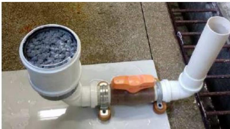
Figura 5. Ensaio de permeabilidade do concreto
