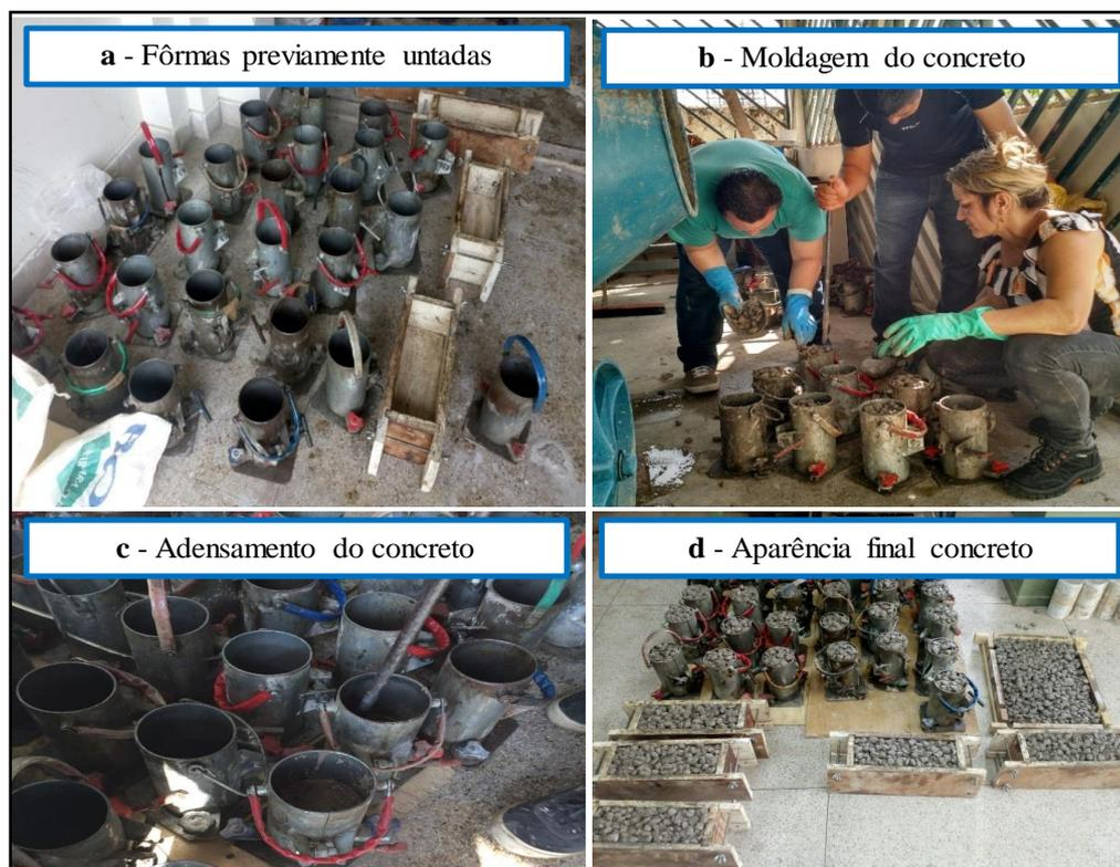
Figura 4. Fabricação do Concreto
