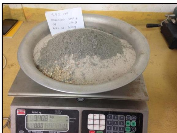
**Figura 5. Pesagem dos agregados**
