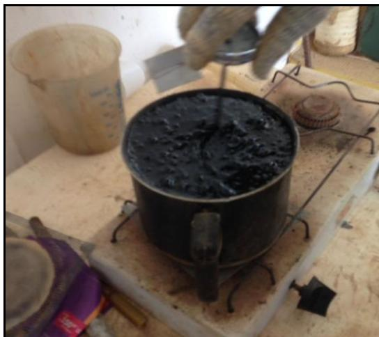
**Figura 7. Processo de aquecimento do CAP**
