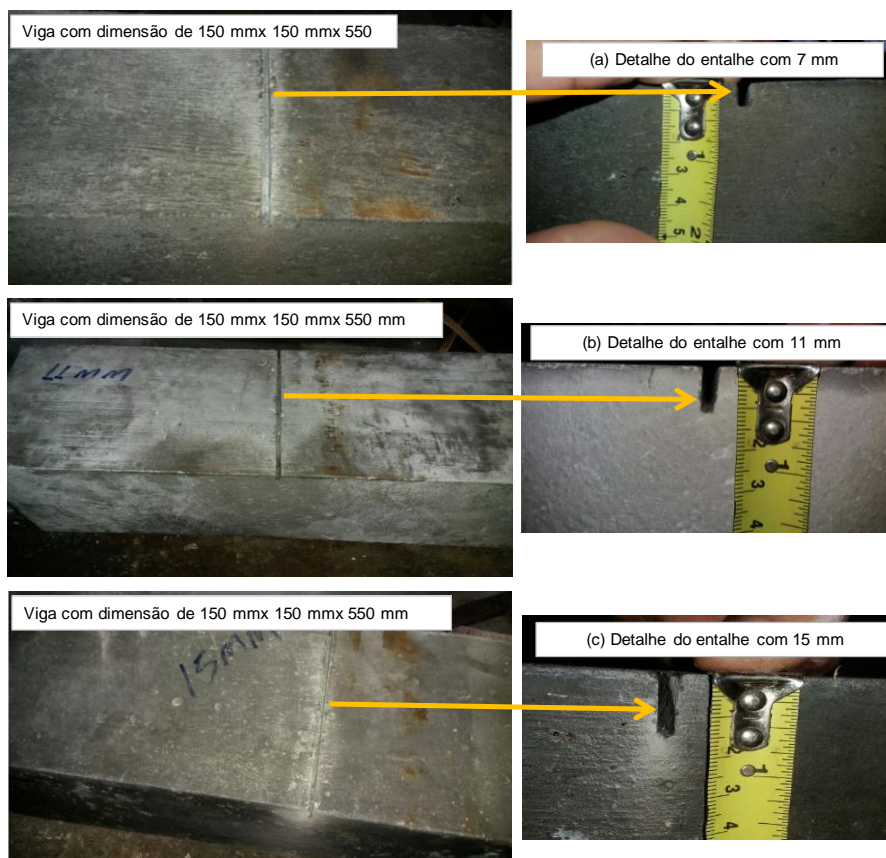
Figura 4. Corpos prismáticos com diferentes entalhes (a) entalhe com profundidade de 7 mm; (b) entalhe com profundidade de 11 mm e (c) entalhe com 15 mm.
