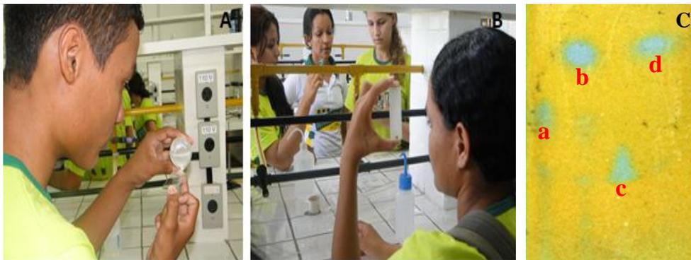
**Figura 4 – A e B) - Cromatoplas de vidro preparadas manualmente com solução de sílica e C cromatoplasca com manchas indicativas de substâncias, conforme descrição: a) óleo de soja; b) biodiesel; c) ácido carboxílico (ácido oleico) e d) biodiesel do óleo de palma.**
