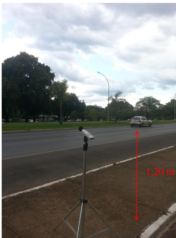
Figura 4 - Montagem e posicionamento do equipamento de medição
