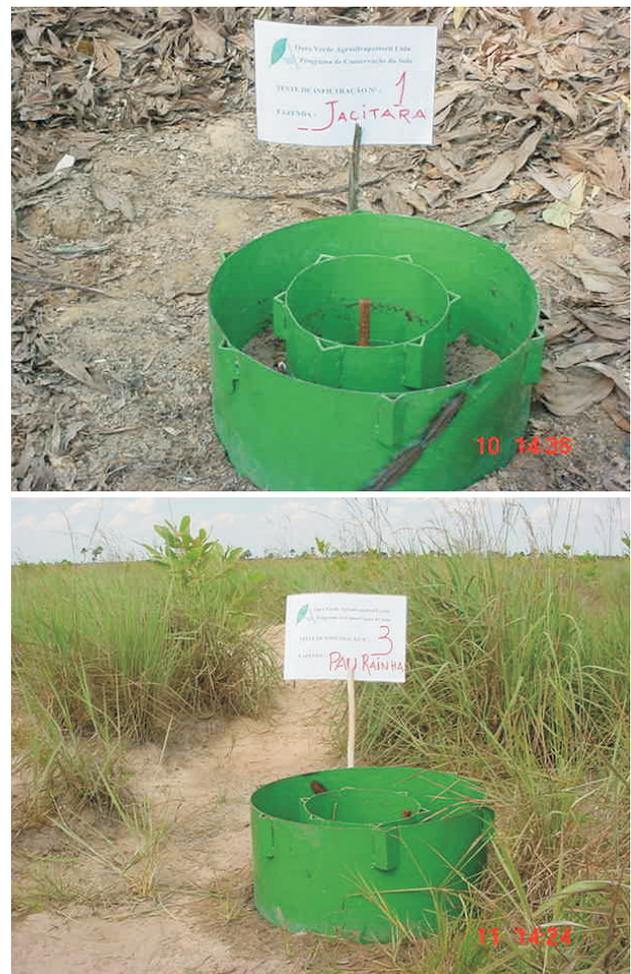
**Figura 3** – Anéis infiltrômetros utilizados no campo para determinação da VI.
