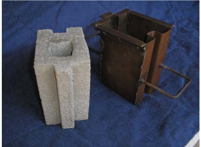
Figura 6: Ilustração dos ecoblocos moldados e da forma de moldação.
