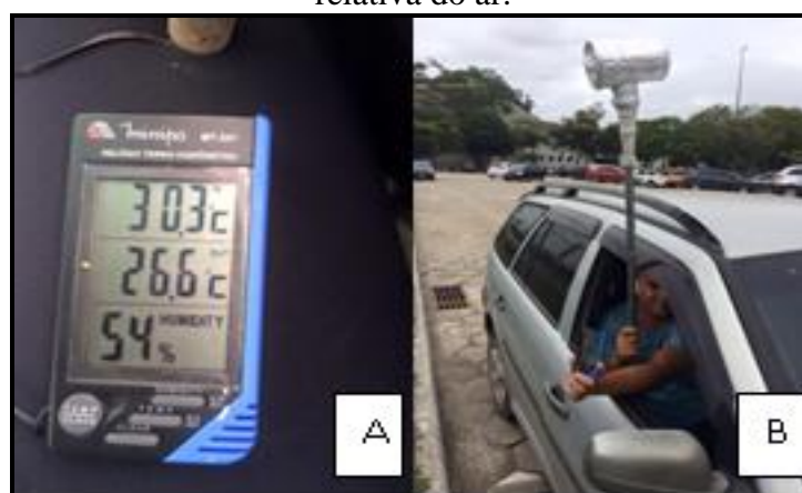
Figura 2 – Equipamentos utilizados para a coleta dos elementos climatológicos: em A, o Relógio Termo Higrômetro In/Out, em B cano PVC para Temperatura do ar e umidade relativa do ar. Foto dos autores/2015.
