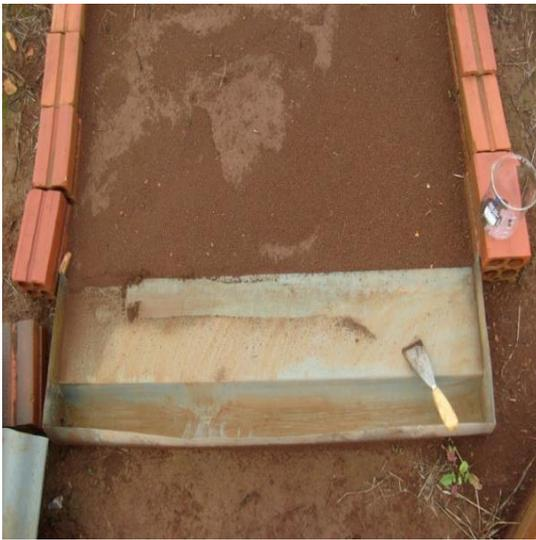
**Figura 2** - Sistema de calha tipo Gerlach.
