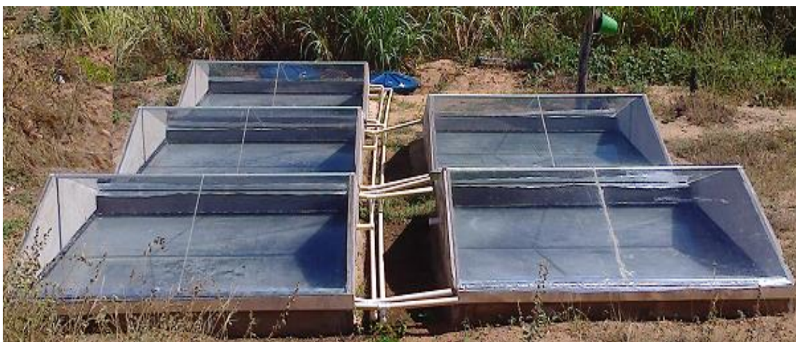
Figura 2: Destiladores Solares no Assentamento Olho D'água, Seridó-PB. Fonte: Arquivo pessoal
