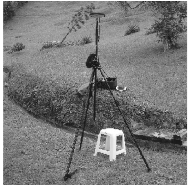
FIGURA 2 - GPS de Alta precisão Promark 33 utilizado no levantamento de campo. Fonte: Asevedo (2010).
